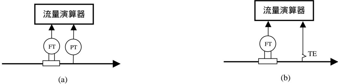
图 4 用旋涡流量计测量饱和蒸汽质量流量系统图
