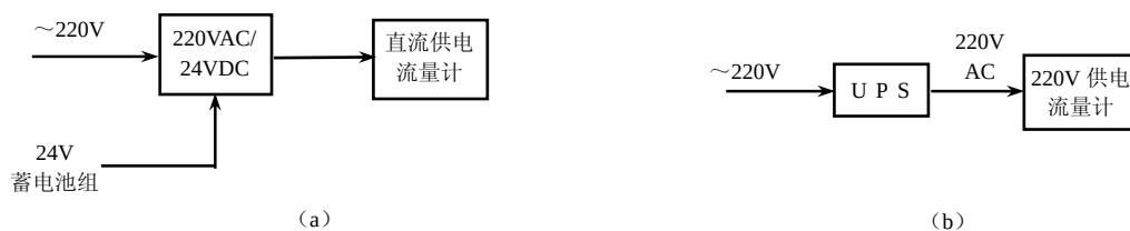
图 3 后备电源供电的流量计
