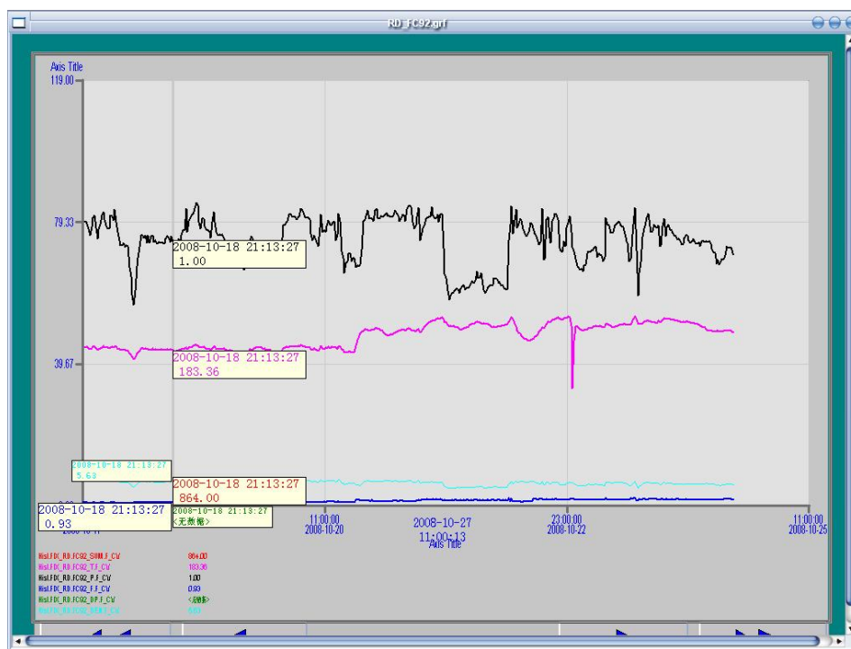
图 6 双量程差压式流量计运行曲线
