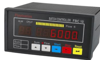
FBC 10 型流量批量控制仪（以下简称仪表）是一种以单片机为基础的，有通讯能力的，带数字显示的流量批量控制仪表，其输入端可与多种流量变送器、传感器配合，其输出接点可与电磁阀配合，组成批量控制系统。通过面板上的操作键可方便地设置定量值和提前值，与大小阀的控制动作相配合，可实现精确定量，广泛用于液体的定量发料、装车、装桶和生产过程中的配料等。
